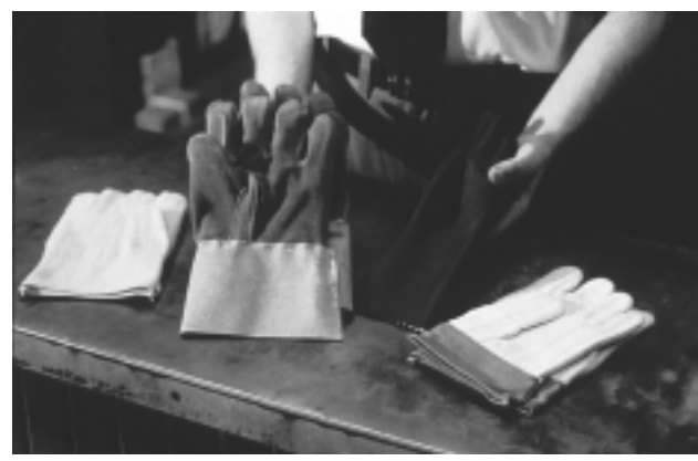
Figura 31.18 • Guantes de fibra natural de longitud suficiente para proteger la muñeca.
