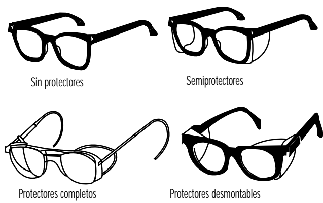
Figura 31.1 • Tipos comunes de gafas de protección ocular, con y sin protectores laterales.
